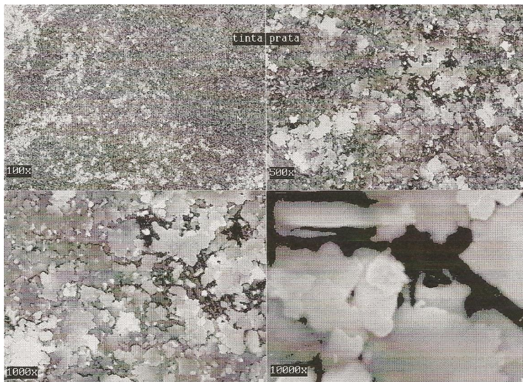
Figura 3- Imagem da tinta prata no MEV Leo 440: magnificação de 100x, 500x, 1000x e 10000x; detector SE.
