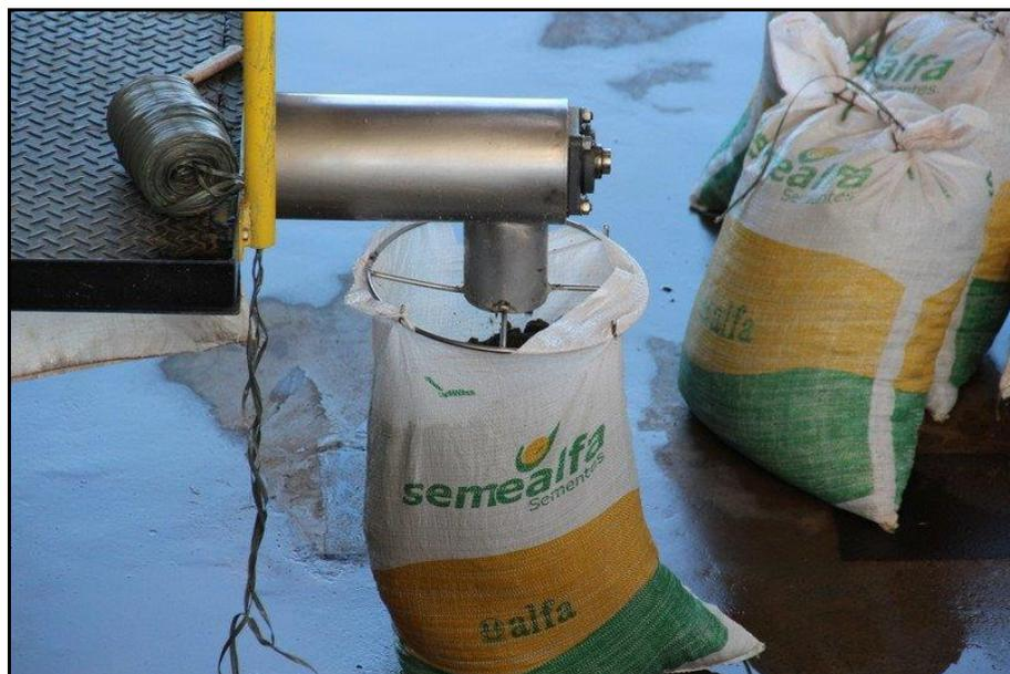
**Foto 4: Processo de Ensaque do Lodo.**
