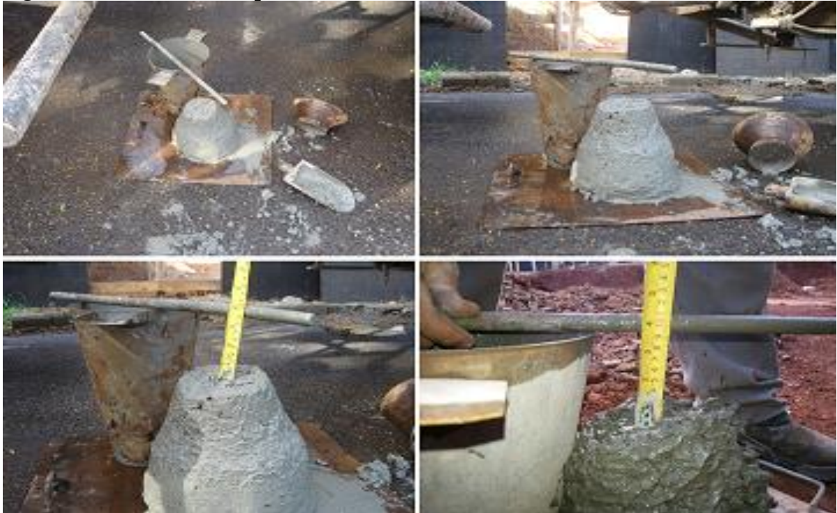
Figura 1 - Executado Slump de Concreto Armado
