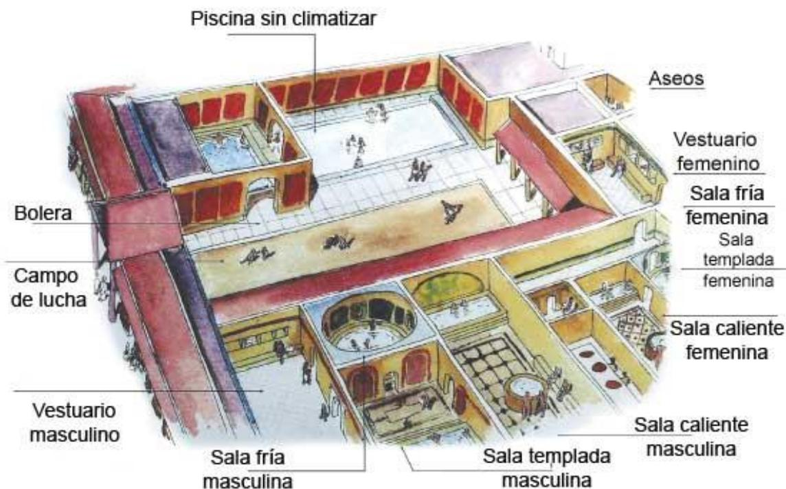
**Figura 05: Desenho esquemático de uma terma**
