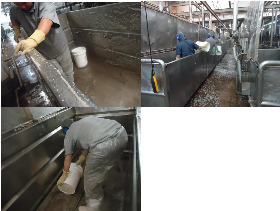
Figura 1 – Processo de higienização dos tanques antigo
