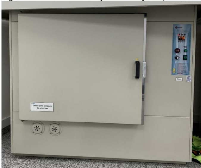
Figura 5 – Estufa com circulação de ar forçada Quimis, utilizada na determinação gravimétrica de umidade.
