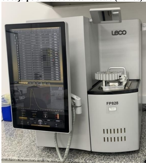
Figura 7 – Analisador de proteína (LECO FP828) utilizado para a determinação de Proteína Bruta no farelo de soja pelo método de combustão (Dumas).
