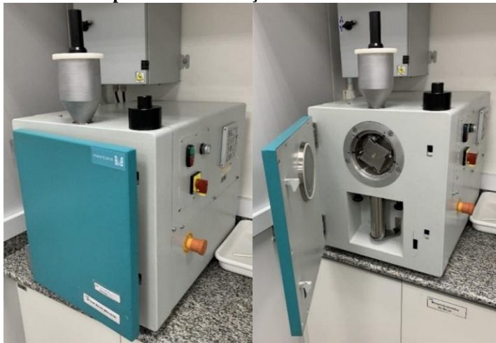
Figura 4 – Moinho de Facas (Marconi MA340) configurado com peneira de 1,7 mm, utilizado no preparo das amostras para a determinação de umidade e leitura no NIR.
