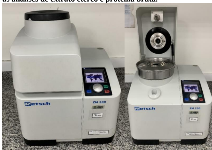
Figura 3 – Moinho Centrífugo (Retsch ZM 200) empregado na obtenção de granulometria de 0,5 mm para as análises de extrato etéreo e proteína bruta.
