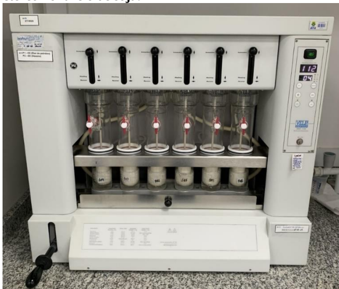
Figura 6 – Extrator de gordura Soxhlet semi-automático (Velp), essencial para a determinação de extrato etéreo no farelo de soja.
