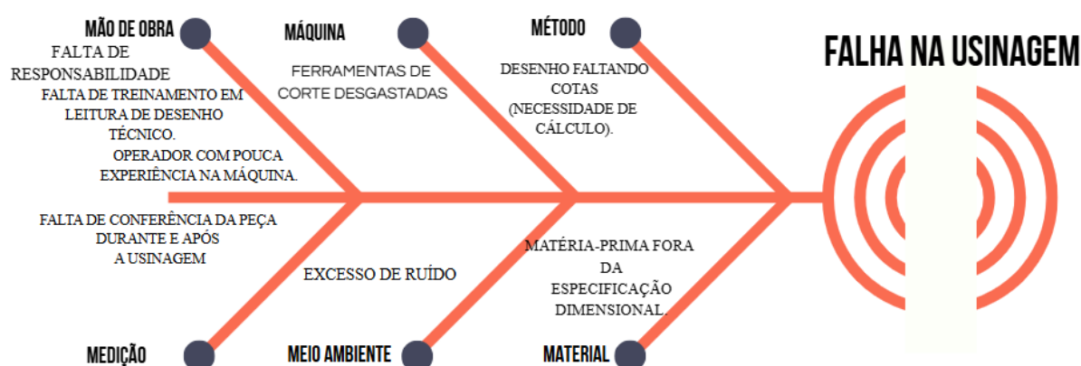
Figura 6 – Espinha de peixe sobre falha na usinagem
