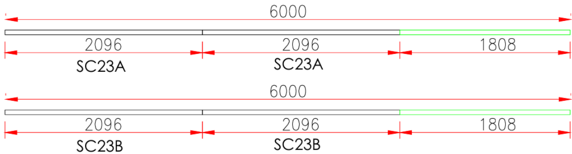
Figura 6 - Forma de corte para a maior otimização de aço
