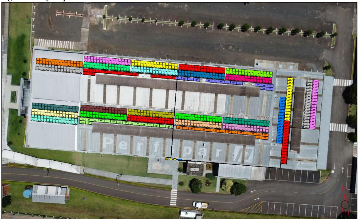
Figura 1 – Layout prévio do sistema fotovoltaico.
