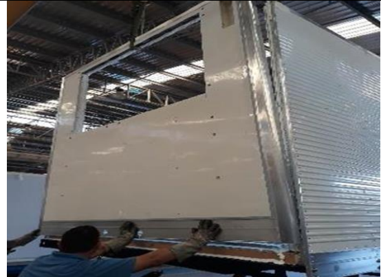
Foto B: Atividade de colocar o painel frontal
