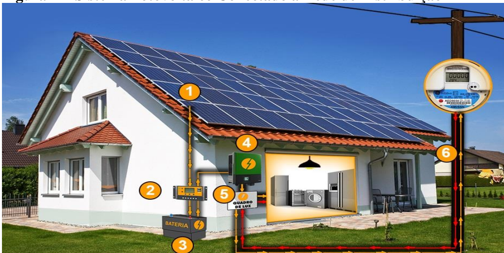
Figura 1 - Sistema Fotovoltaico Conectado a Rede de Distribuição
