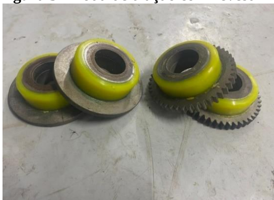
Figura 3 - Roda de tração com revestimento PU1
