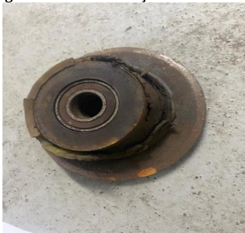
Figura 2 - Roda de tração com revestimento PU1
