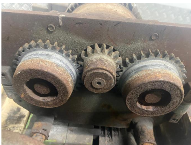
Figura 1 - Roda de tração sem revestimento
