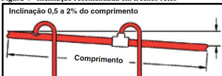
Figura 4 - Inclinação recomendada em trechos retos
