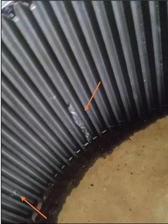
Figura 11 – Engrenagem anelar indicando falha nos dentes
