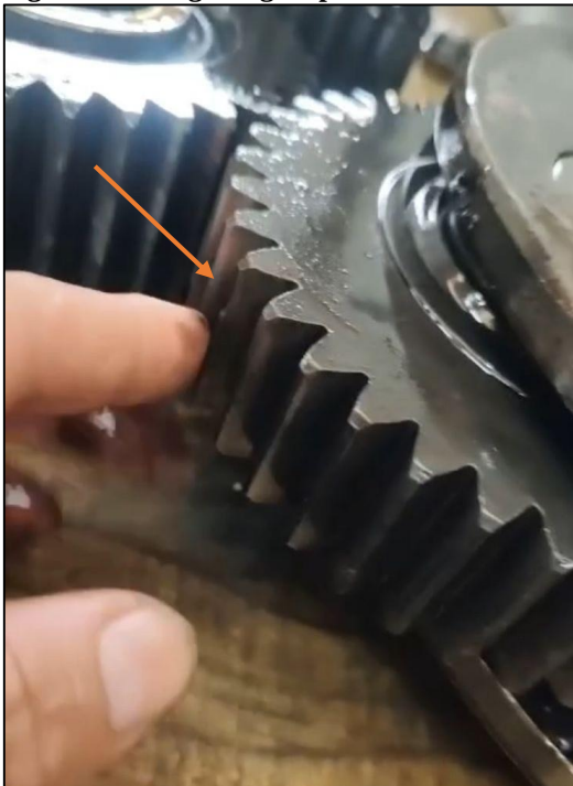
Figura 12 – Engrenagem planetária n° 1 indicando marcas
