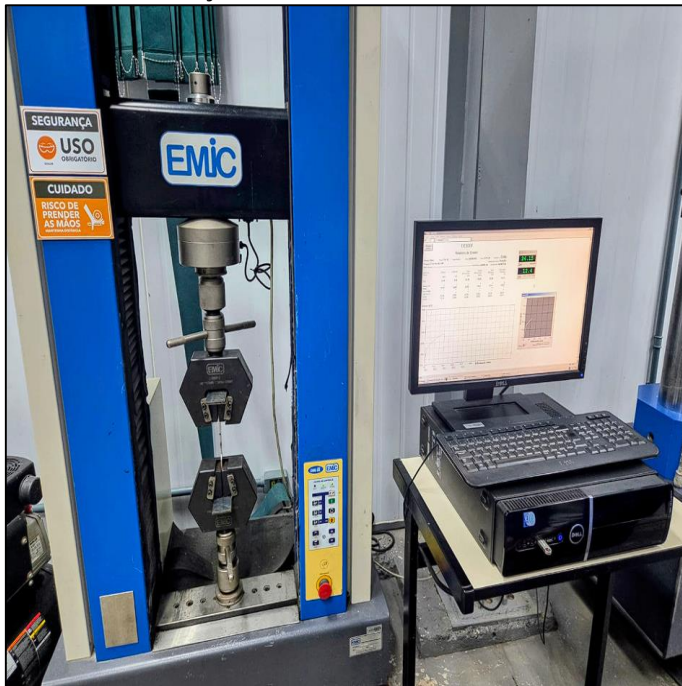
Figura 10 – Máquina Universal de Ensaios EMIC com capacidade de 100KN, utilizada para a realização dos ensaios de tração no laboratório.
