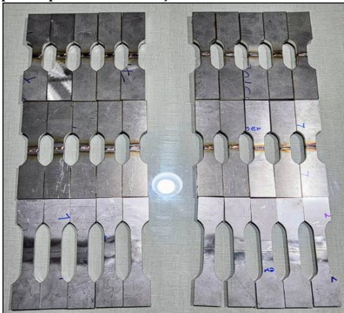
Figura 9 – Corpos de prova físicos em aço AISI 304, após os processos de soldagem (TIG e laser ) e corte, prontos para o ensaio de tração.
