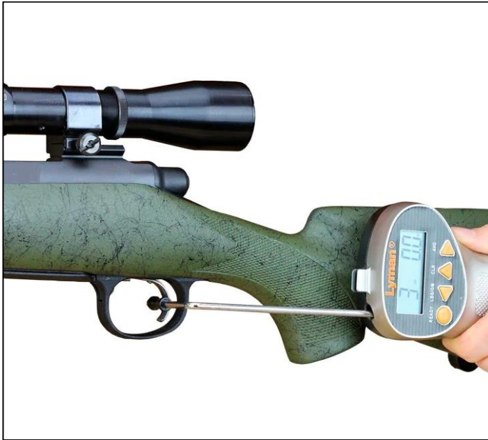
Figura 16 – Medição do peso do gatilho.
