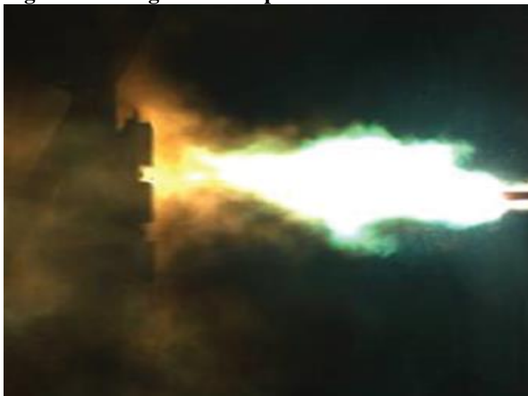
Figura 3 – Imagem do comportamento físico de um arco elétrico
