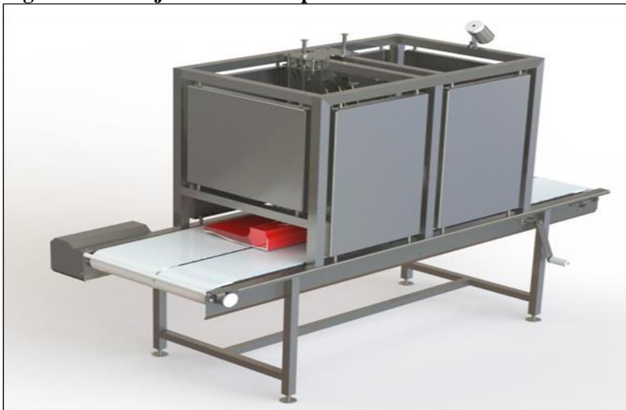
Figura 16 – Conjunto de cortes primários com o novo mecanismo
