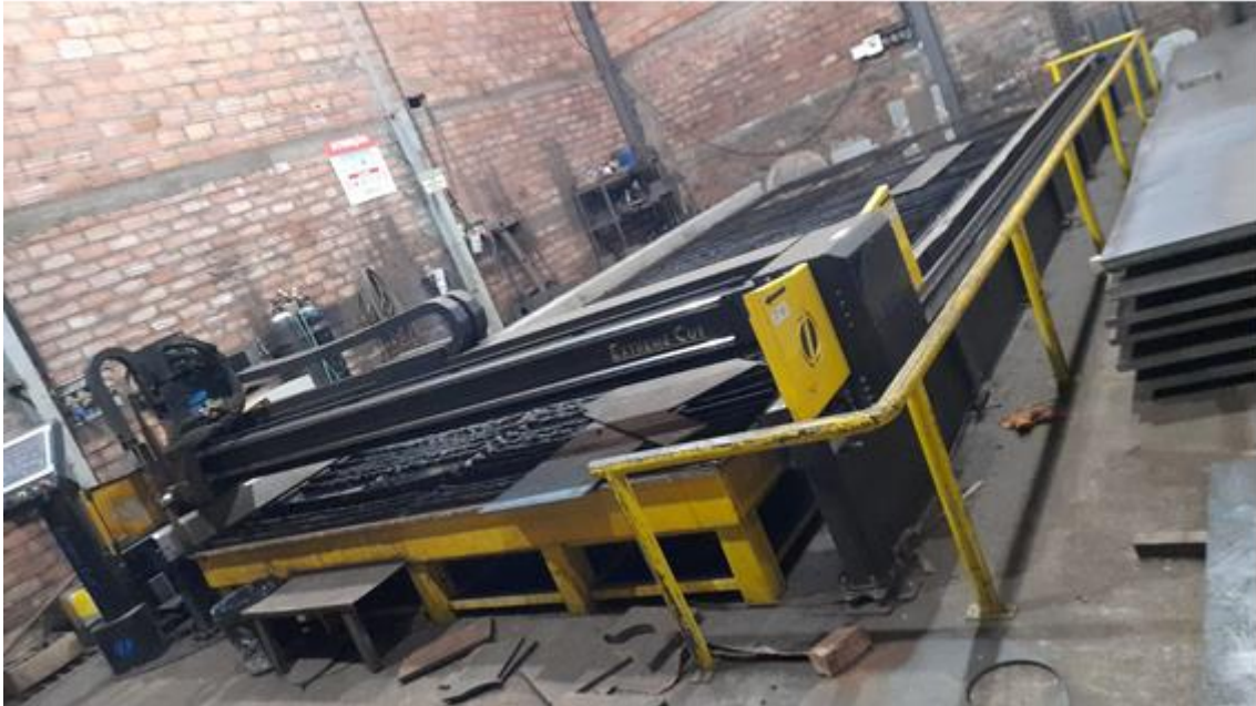
Figura 3 - Máquina de Corte a Plasma e Oxicorte Extreme Power 125 HF
