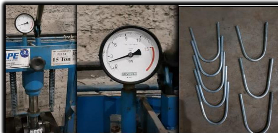
Figura 8: Ensaio de dobra (vergalhão)
