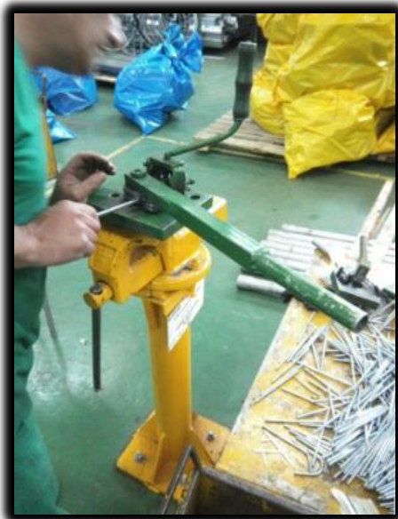
Figure 8: Processo de dobra de abraçadeira tipo ‘U’ - vergalhão
