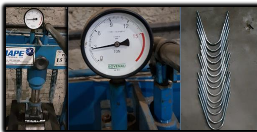
Figura 9: Ensaio de dobra (vergalhão)
