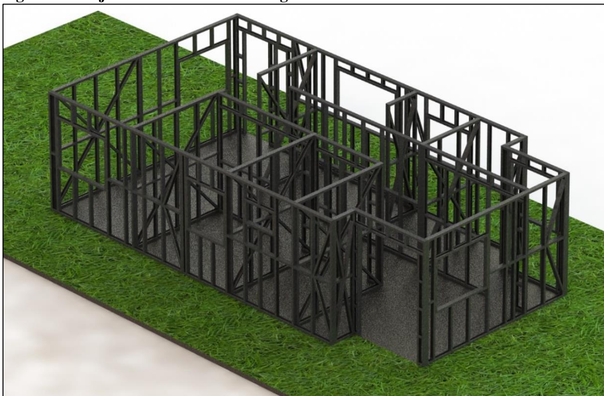
Figura 7 - Projeto Básico da Casa em Light Steel Frame
