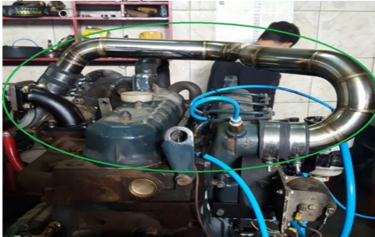
Figura 8 – Interligação turbina com sistema de admissão
