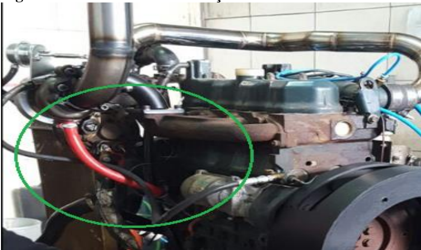
Figura 10 - Sistema de lubrificação
