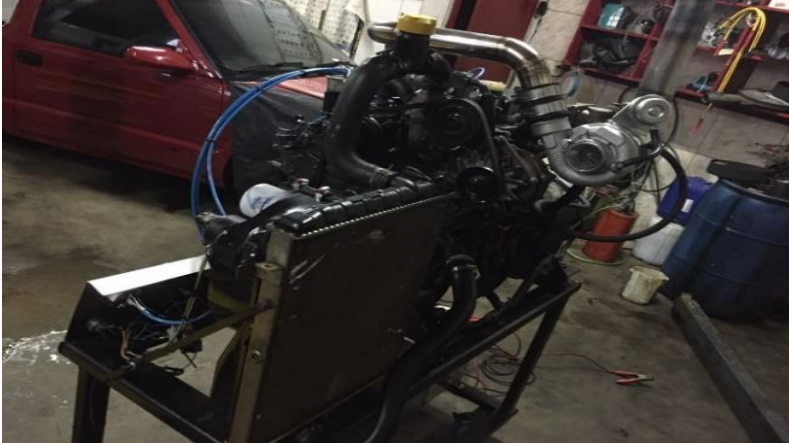
Figura 13 - Motor com sistema de sobrealimentação por turbocompressor
